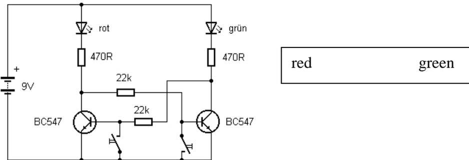
Fig. 28: A bistable flip-flop (Schaltung9.jpg)
