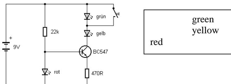
Fig. 24: A stabilised current source (Schaltung7.jpg)
