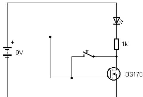
Fig. 42: The electrometer (Schaltung16.jpg)
