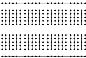
Fig. 2: The internal contact rows (Kontakte.gif)
