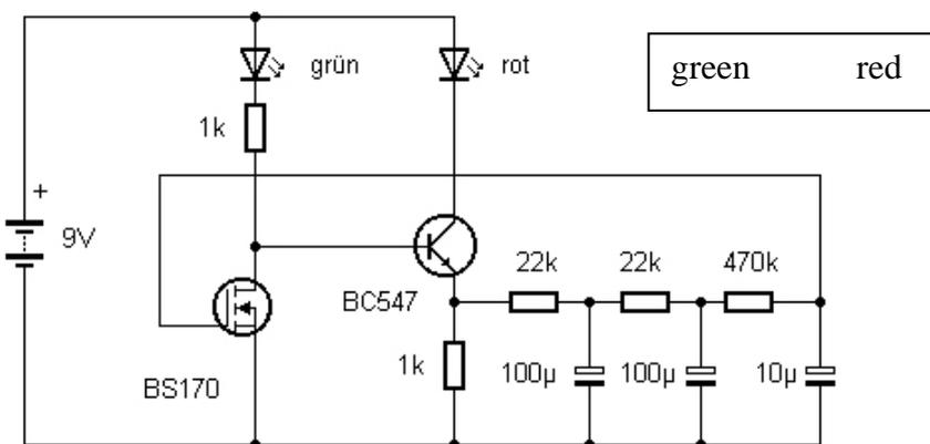
Fig. 50: A phase shifter oscillator (Schaltung20.jpg)
