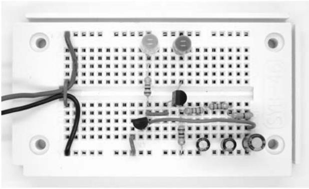
Fig. 51: The soft flasher (Aufbau20.jpg)
